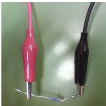
Εικόνα 5-3: Μέτρηση τιμής τις αντίστασης με το πολύμετρο
