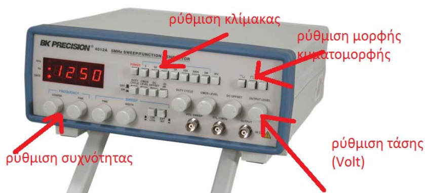
Εικόνα 9-6: Ρύθμιση συχνότητας, τάσης, κυματομορφής και κλίμακας στο πολύμετρο
