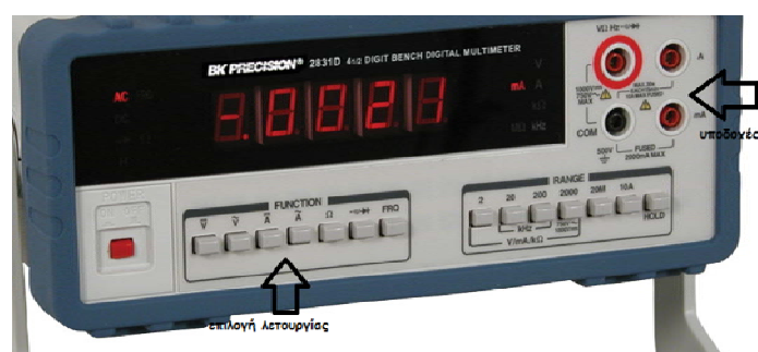
Εικόνα 7-9: Κουμπιά λειτουργιών και βύσματα πολυμέτρου
