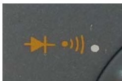
Εικόνα 5-2: Επιλογή για μέτρηση της συνδεσιμότητας του κυκλώματος
