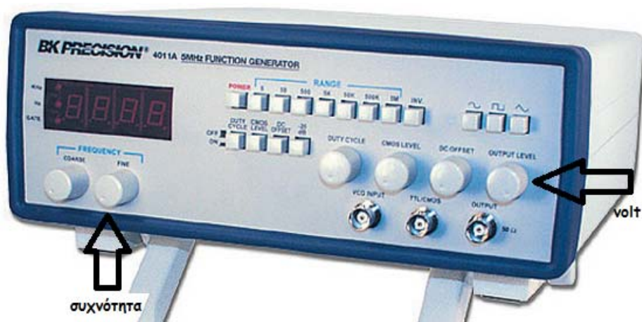
Εικόνα 7-15: Ρύθμιση πλάτους-συχνότητας σήματος γεννήτριας
