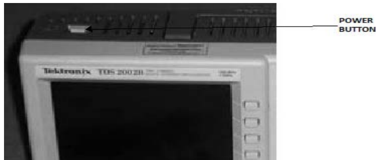
Εικόνα 6-5: Διακόπτης λειτουργίας Παλμογράφου
