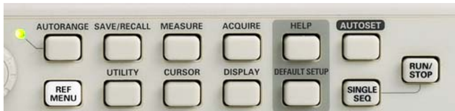
Εικόνα 6-10: Κουμπιά λυτών λειτουργιών παλμογράφου
