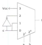
(3) Αν συνδέσουμε στην είσοδο επιλογής στον πολυπλέκτη τελευταίου επιπέδου το  $a$ , τότε θέλουμε για  $a = 0$ , να έχουμε  $F = c$  και για  $a = 1$  να έχουμε  $F = b + \bar{c}$ . Για να υλοποιήσουμε τη τελευταία συνάρτηση χρησιμοποιούμε έναν ακόμη πολυπλέκτη με σήμα επιλογής το  $c$  (βολεύει μιας και δεν έχουμε αντιστροφείς). Για  $c = 0$  θέλουμε έξοδο 1, ενώ για  $c = 1$ , θέλουμε έξοδο  $b$  ώστε να παίρνουμε στην έξοδο του την  $b + \bar{c}$ . Συνεπώς το ζητούμενο σχήμα είναι :
